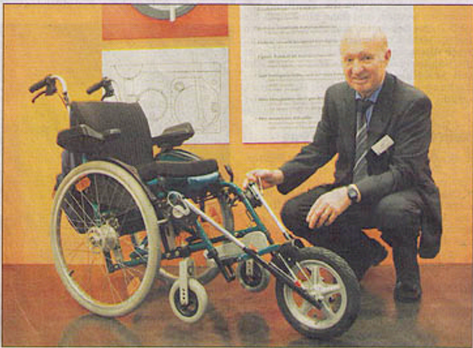
Walter Föhl mit dem von ihm konstruierten Rollstuhl, der dank eines zusätzlichen Vorsatzrades im Innen- und Außenbereich gleichermaßen beweglich ist.
