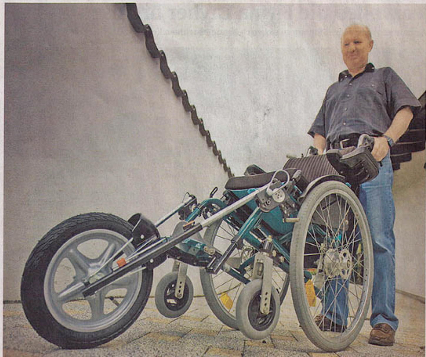
Walter Föhl mit dem aufgerüsteten Rollstuhl. Auch geschotterte Wege lassen sich damit bewältigen.
